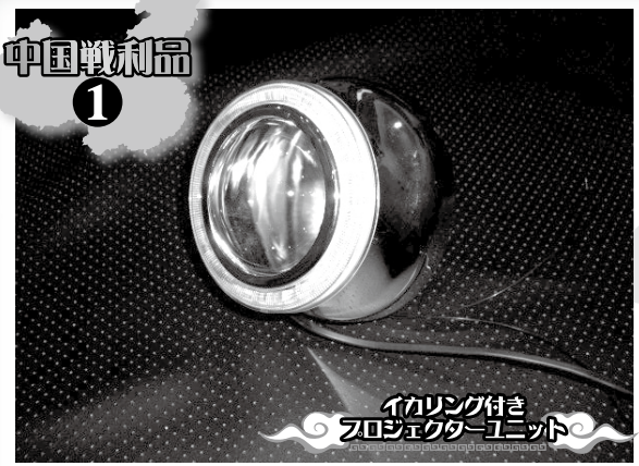
このデメキンみたいなアイテムは、イカリリング付きのプロジェクターユニット。これをヘッドライトに内蔵すれば、いま風のお目玉! イカリリングは白と赤と青のLEDから選べる。
